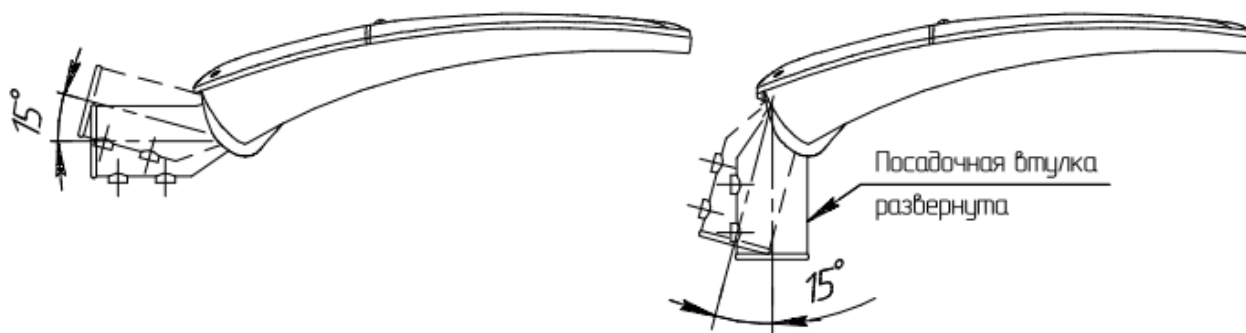
Рисунок 1.3 – Углы наклона светильника
